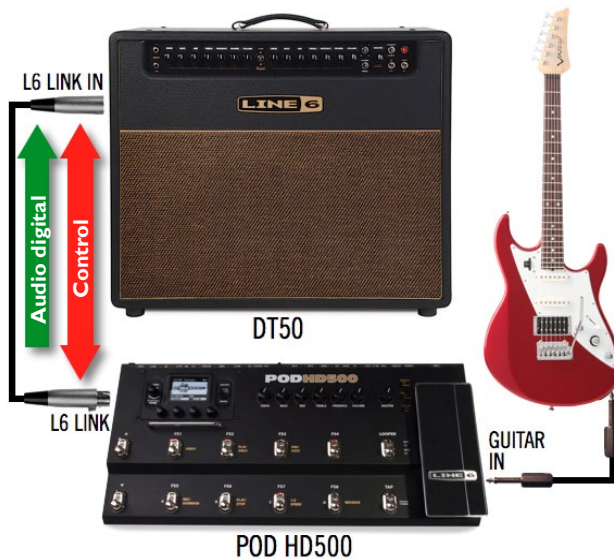
POD HD500 conectado al DT50 mediante L6 LINK
