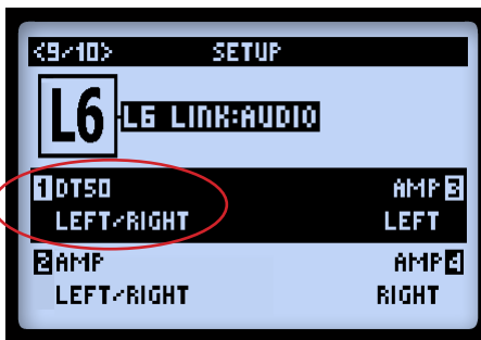
La pantalla L6 LINK:AUDIO - Amplificador 1 ajustado a Left/Right
