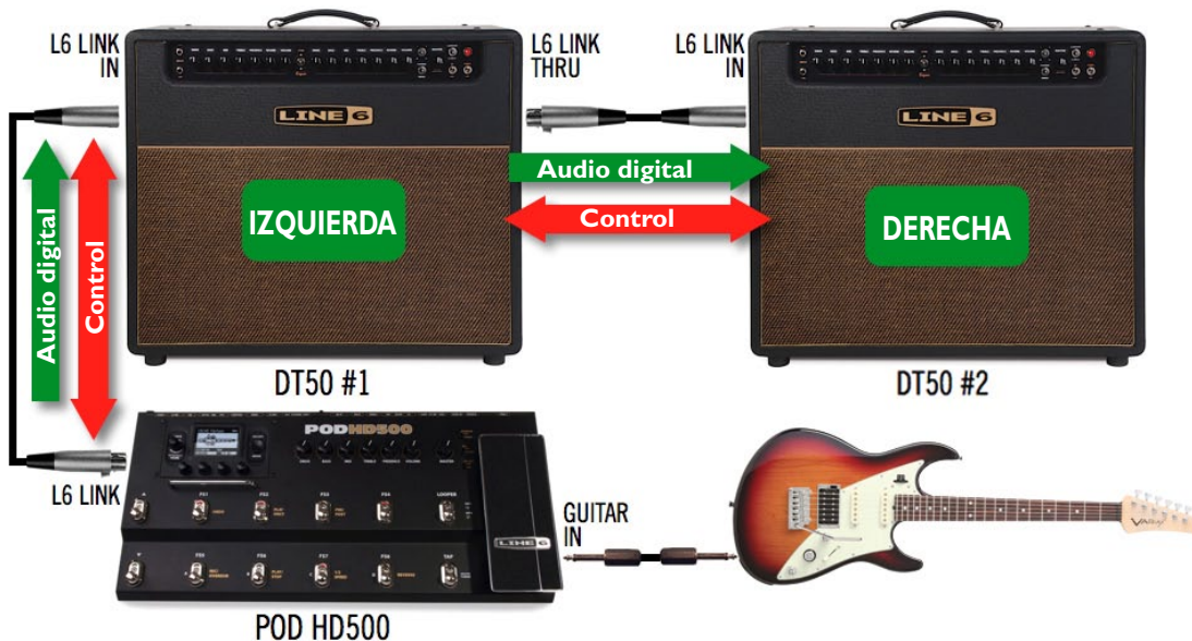
Configuración estéreo con dos amplificadores DT
