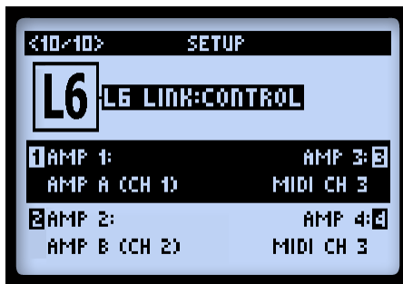
La pantalla L6 LINK:CONTROL - AMP 1 está ajustado para seguir a AMP A (CH1)
